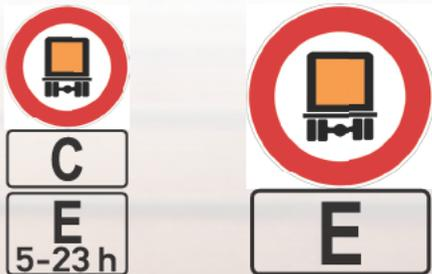
Während ein Tunnel der Tunnelkategorie A für alle Gefahrgutbeförderungen uneingeschränkt durchfahren werden kann, ist ein Tunnel der Tunnelkategorie E für alle Gefahrgutbeförderungen gesperrt, bis auf die in diesem Merkblatt aufgeführten Ausnahmen. Die Tunnelkategorien B, C und D schränken die Durchfahrt von gewissen Gefahrgütern ein.
